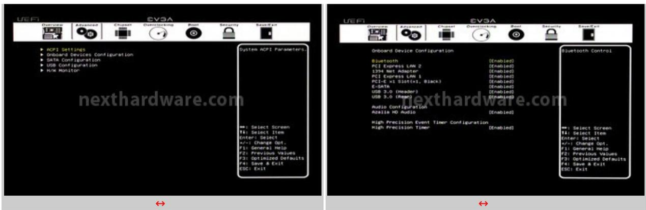
Tutti i controller presenti sono disattivabili singolarmente per migliorare i tempi di Boot o per evitare la configurazione di periferiche che, a priori, sappiamo già di non voler utilizzare.
