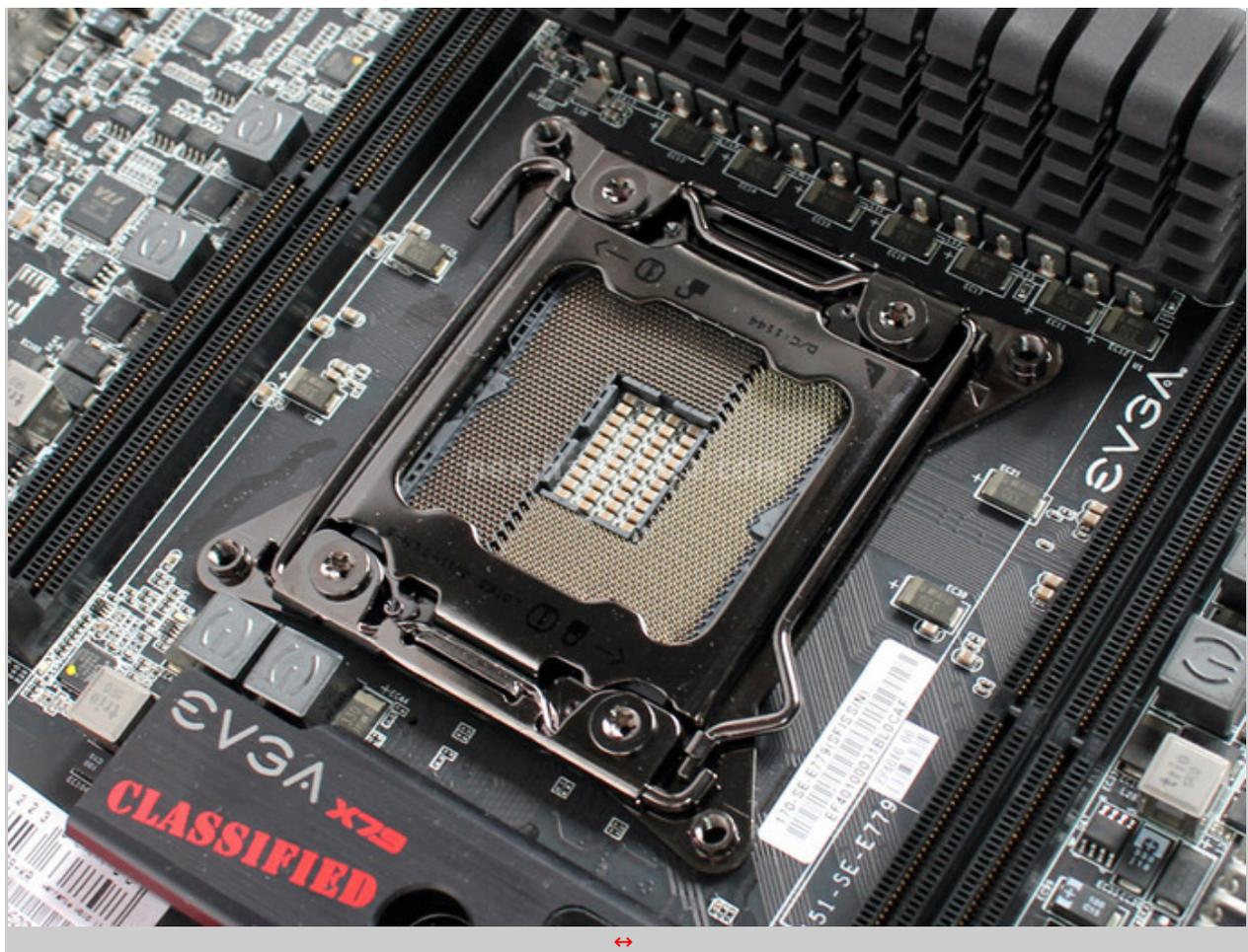
Il sistema di ancoraggio scelto per il microprocessore è un'ulteriore prova della cura dedicata a questo progetto, ovvero 2011 piedini arricchiti con il 300% di materiale nobile in più rispetto alle soluzioni concorrenti e ancorati meccanicamente al migliore socket Lotes in commercio.
