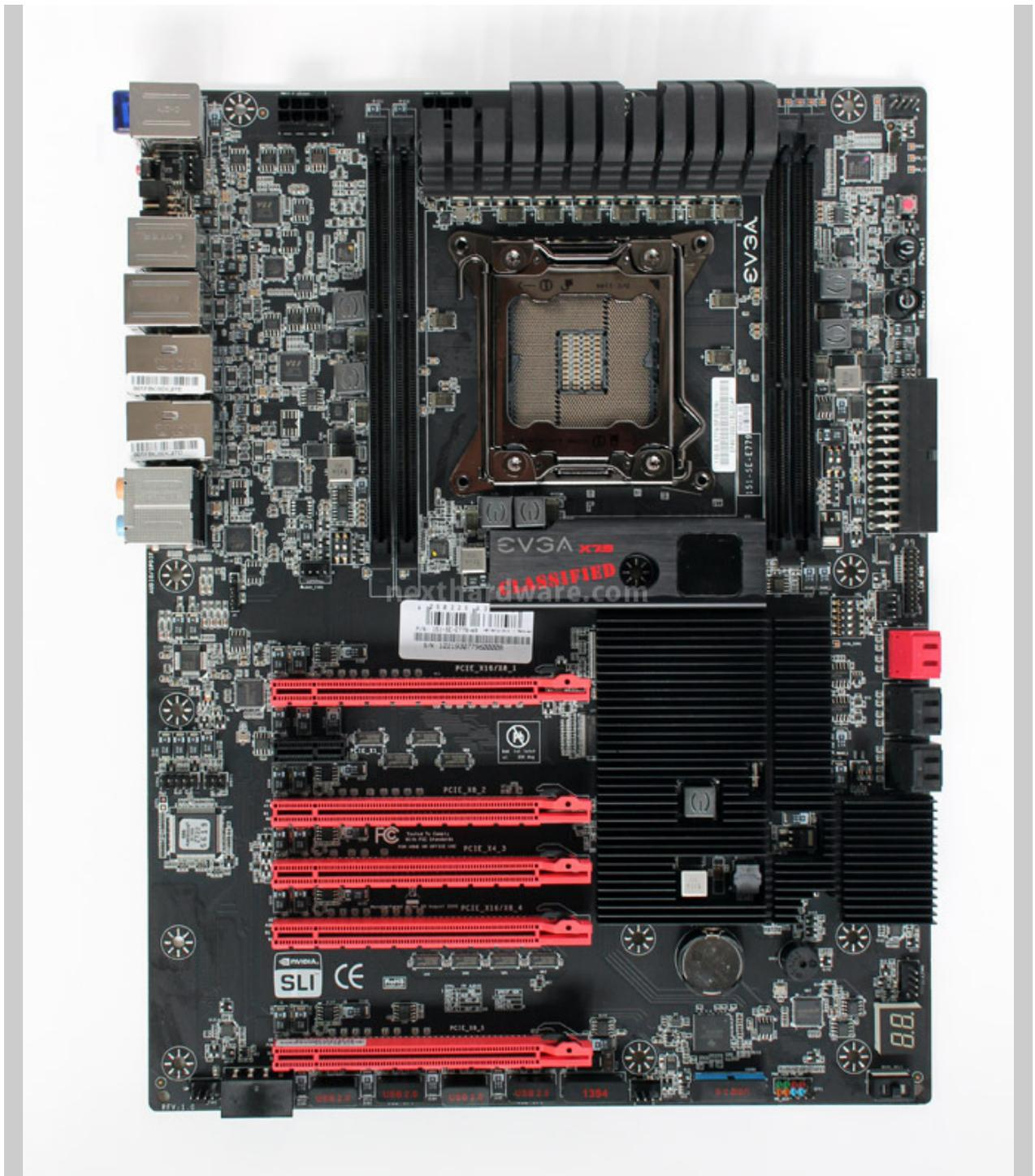
La struttura del PCB ha un layout pulito ed ordinato; vicino al socket della CPU è possibile scorgere il voluminoso sistema di raffreddamento dei mosfet di alimentazione.
