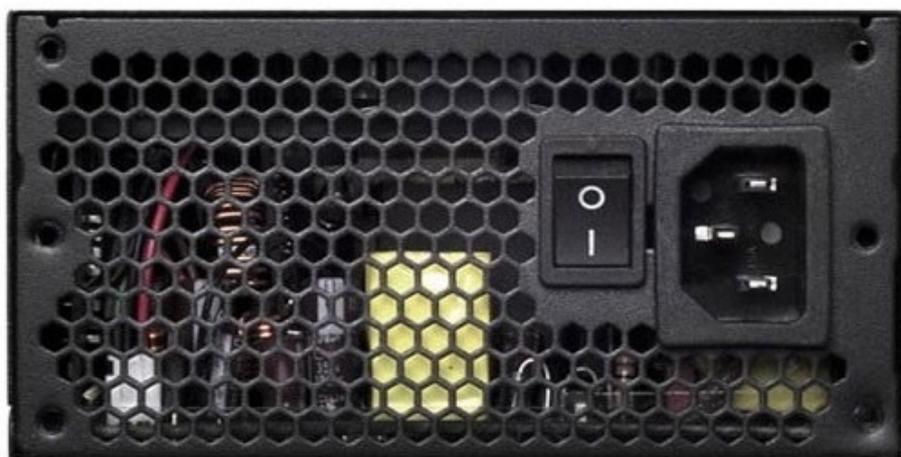
Il SilverStone SX500-LG è dotato di un singolo RAIL da + 12V, APFC, e tutte le protezioni previste sugli alimentatori di ultima generazione.
