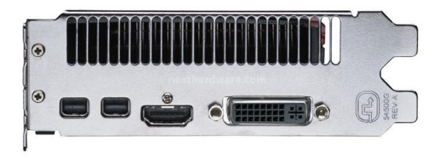
I modelli di riferimento integrano una singola porta DVI Dual Link (con supporto per un singolo monitor VGA), una HDMI High Speed (3D e High Definition) e due connessioni mini DisplayPort.
