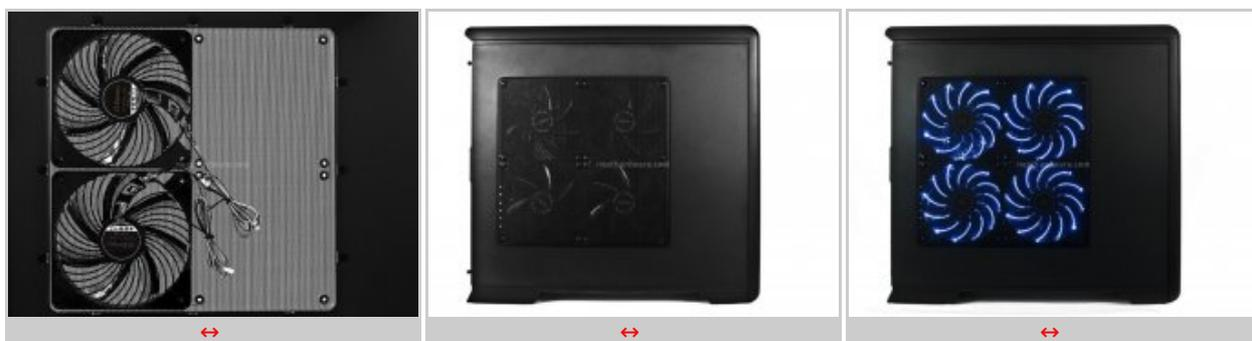
Il pannello laterale sinistro nella sua configurazione standard monta solo due ventole da 180mm, ma noi, grazie ad un set completo di ventole inviatoci da Enermax, siamo in grado di mostrarvi come appare lo chassis con tutte e quattro le ventole installate: la foto parla da sé, un risultato davvero eccezionale.
