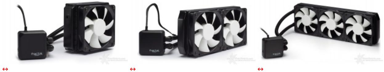
A distanza di circa otto mesi tali modelli sono stati finalmente ufficializzati sotto il nome di Kelvin T12, S24 e S36, rispettivamente con radiatore da 120mm, 240mm e 360mm.
