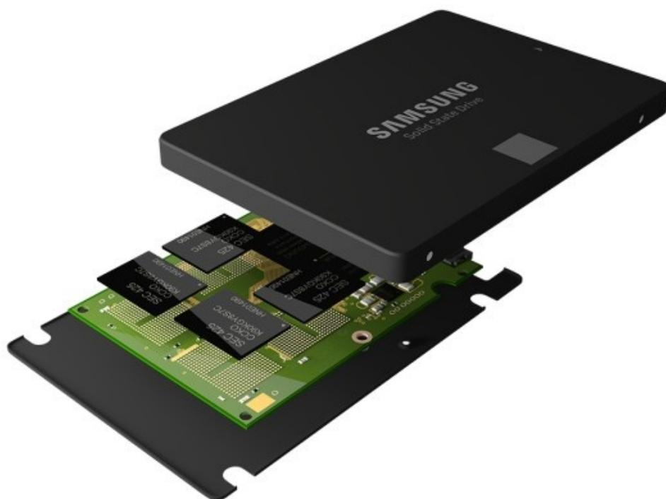
Mentre il Samsung 850 PRO, uscito nel mese di luglio, utilizza delle 3D V-NAND 2-bit per l'uso professionale in PC client high-end e server aziendali di piccole e medie dimensioni, il nuovo 850 EVO è stato costruito intorno alle memorie 3D V-NAND 3-bit per un uso più generico in dispositivi come notebook e PC gaming.
