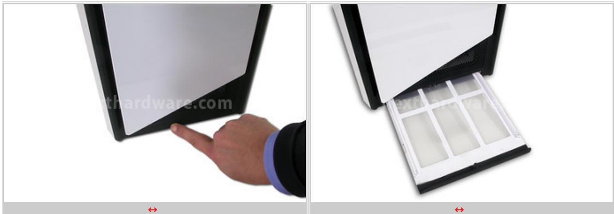
La presenza di numerosi filtri antipolvere in un case è da considerarsi un valore aggiunto: preservare l'interno del case dagli accumuli di polvere mantiene le prestazioni dei dissipatori ad un livello costante e riduce la frequenza con la quale effettuare le comuni operazioni di pulizia.
