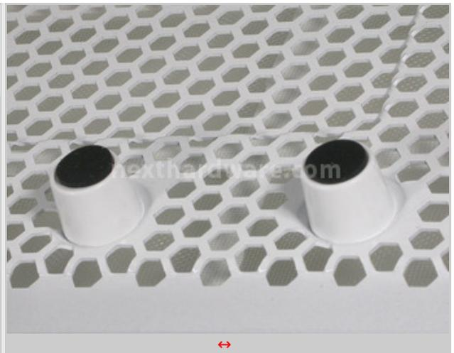
La cura dei particolari posta da NZXT nello Switch 810 è evidente anche nella realizzazione della superficie di appoggio dell'alimentatore: ben sei distanziali dotati di gommini si occupano di accogliere la nostra unità smorzandone completamente le vibrazioni prodotte.
