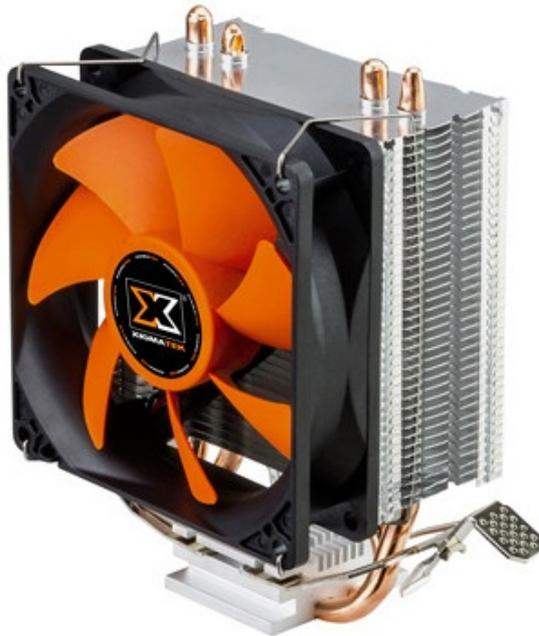
Il TYR-SD962 è dotato di un corpo dissipante realizzato con alette in alluminio collegato alla base tramite due heatpipes in rame dello spessore di 6mm.
