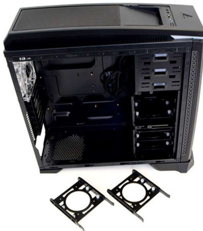
Internamente il GX300 può ospitare schede madri in formato ATX o inferiore e vi è sufficiente spazio per schede grafiche con una lunghezza massima di 400 mm.
