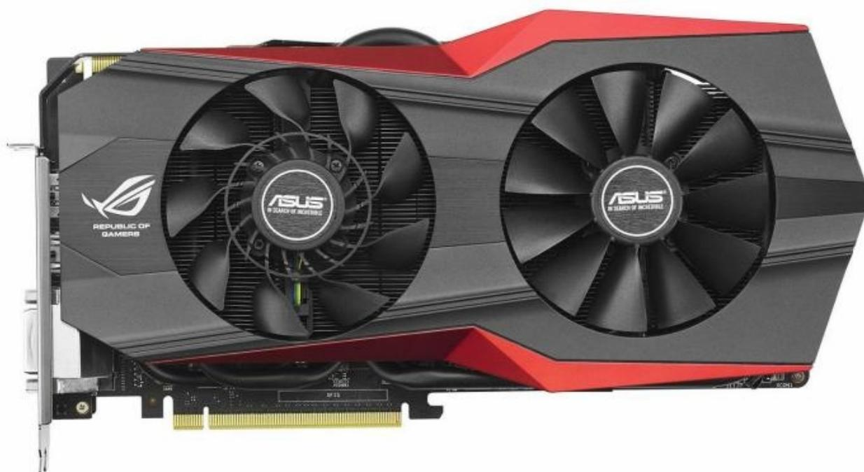
La ventilazione è affidata a due distinte unità , di cui una tradizionale da 100mm ed una da 92mm con tecnologia CoolTech.
