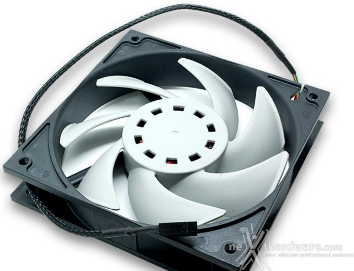
Le caratteristiche salienti vedono una dimensione fissa di 120mm, uno speciale design delle sette pale di cui sono dotate, un'alta pressione statica, una bassa rumorosità e diversi regimi di rotazione massimi in base al modello prescelto, da 1150 sino a 3000 RPM.
