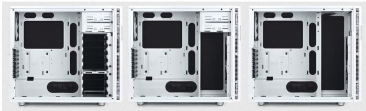
Tolte le paratie si può apprezzare l'ampio spazio interno e la completa modularità del comparto di storage, in quanto tutti i cestelli per i drive possono essere ruotati, rimossi ed installati in altre parti del case.
