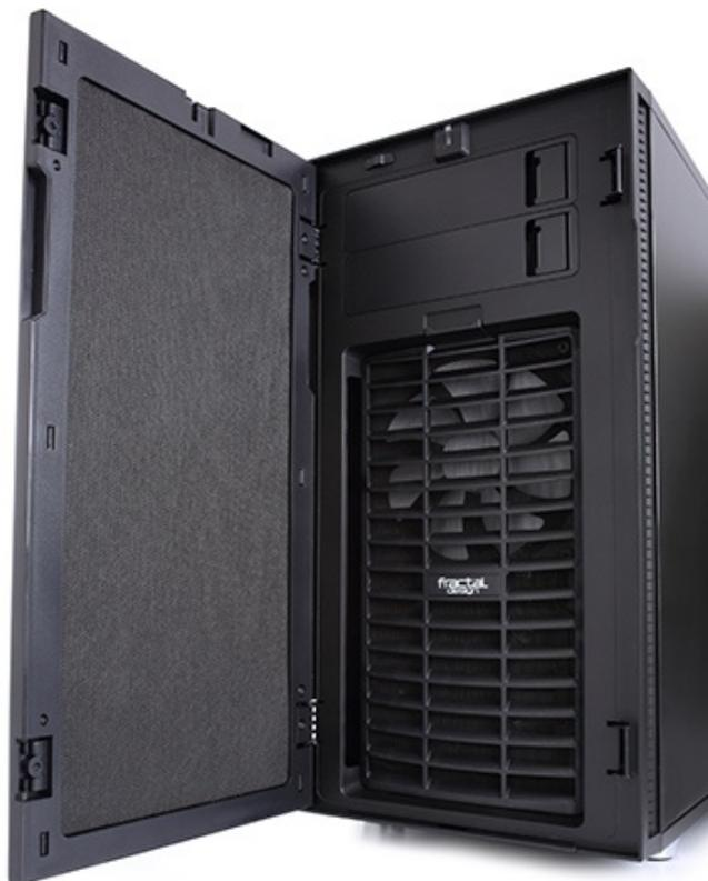
Il frontale è caratterizzato dal tipico pannello in alluminio anodizzato della serie Define, dietro al quale si celano, dall'alto verso il basso, il LED di stato, un regolatore per ventole a tre velocità, due predisposizioni per ODD ed un'ampia griglia removibile a protezione di due Fractal Design Dynamic GP14 da 140mm (una in dotazione).
