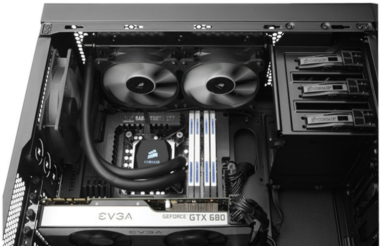
Il Carbide 330R utilizza inoltre un layout interno denominato Direct Airflow, che fornisce un percorso libero tra la ventola da 140mm in dotazione ed i componenti più caldi del sistema, ovvero la CPU e la GPU.
