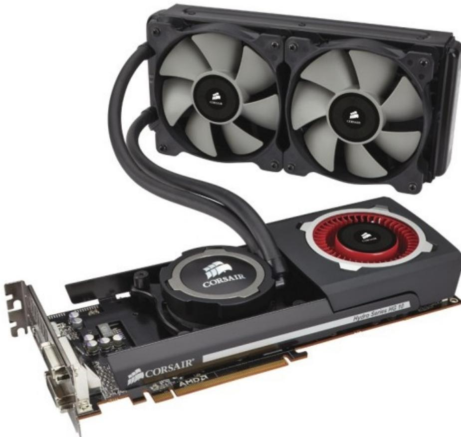
In poche parole, l'AiO raffredderà la GPU e la ventola si occuperà di tenere sotto controllo le temperature dei moduli di tensione (VRM), ottenendo una soluzione in grado di abbattere notevolmente le temperature e, soprattutto il rumore che, come ben sappiamo, risulta particolarmente fastidioso nelle VGA di punta di casa AMD che utilizzano il dissipatore standard.
