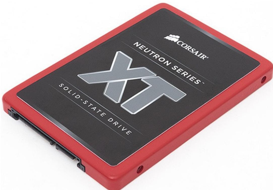
Il Neutron XT è basato su controller quad core Phison PS3110 a otto canali e chip NAND Flash Toshiba A19nm in configurazione MLC.
