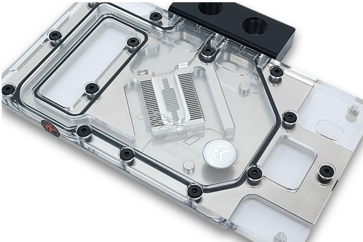
Il waterblock dispone di un diffusore centrale particolarmente ottimizzato per accelerare il flusso sulla GPU, funzionando indifferentemente dal verso di ingresso e offrendo una moderata resistenza, così da essere utilizzato anche in abbinamento a pompe non particolarmente potenti.
