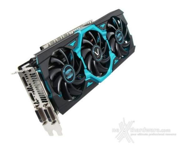
Stiamo parlando della nuova SAPPHIRE R9 290X 8GB Vapor-X OC che, oltre ad essere caratterizzata dalle avanzate tecnologie proprietarie e dal performante sistema di raffreddamento Tri-x unito all'utilizzo di una Vapor Chamber, è contraddistinta da un buon overclock di fabbrica applicato su GPU e VRAM.
