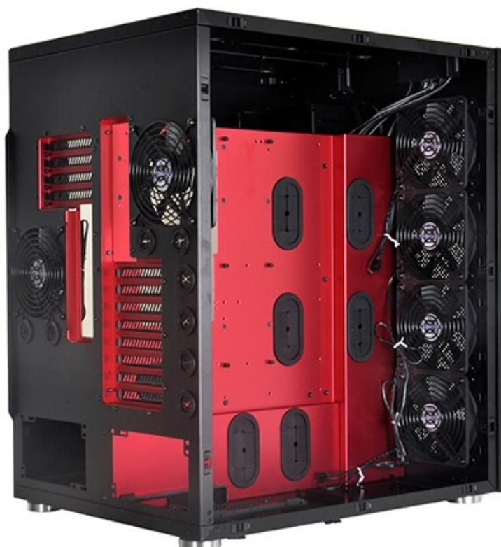
Tutte le predisposizioni per ventole potranno essere utilizzate per il montaggio di enormi radiatori, dall'elevato spessore, senza compromettere le operazioni in fase d'assemblaggio.
