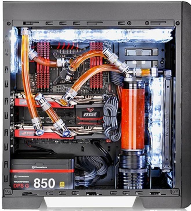
Tutto ciò si traduce in una elevata capienza relativa ai radiatori, nello specifico uno da 360 o 280mm sul frontale, un secondo delle stesse dimensioni sul top ed un terzo da 120mm installato posteriormente.
