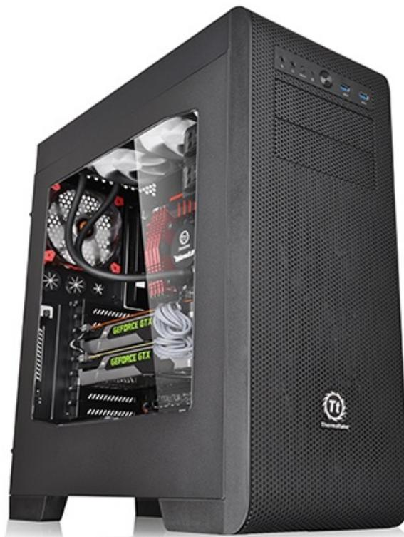
Il caratteristico stile della serie è ancora una volta evidente sul frontale, composto interamente da un pannello traforato in grado di facilitare il ricircolo dell'aria all'interno del case.
