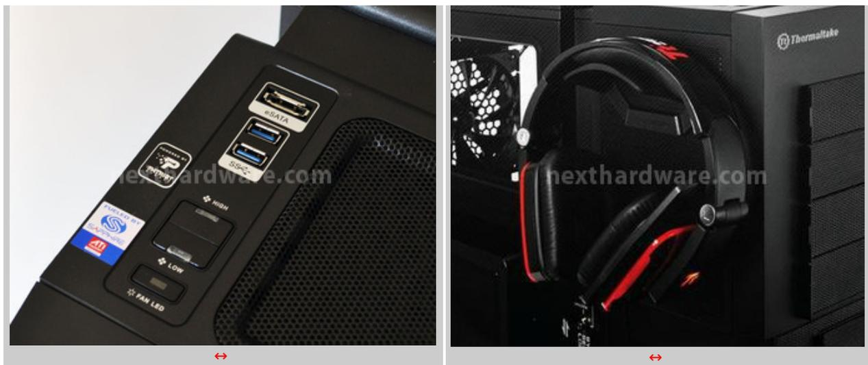
Sull'I/O panel situato sul top dello chassis sono presenti due porte USB 3.0, una connessione eSATA, due pulsanti che regolano la velocità delle quattro ventole integrate ed un terzo pulsante che modifica la colorazione dei led delle stesse, alternando i vari colori e impostandone lâ€™™ intermittenza.
