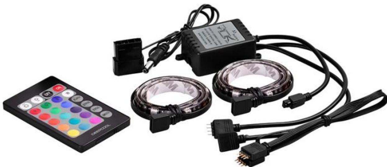
Il nuovo case, infatti, utilizza due strisce di LED RGB alimentate tramite un connettore molex a 4 pin e abbinata ad una unità di controllo che consente di scegliere il colore.
