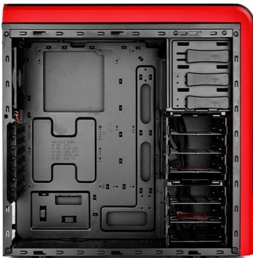
Il sistema di raffreddamento comprende una ventola posteriore da 120mm, due predisposizioni per unità da 120 mm sul frontale, una da 120 mm sul fondo e due, sempre da 120mm, sul top.
