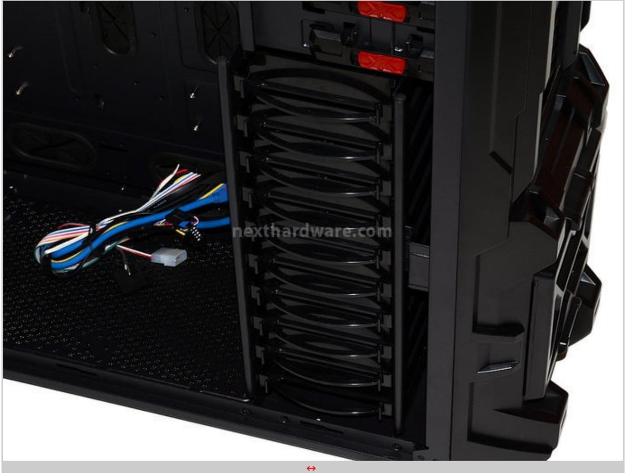
Ognuna delle dieci slitte per i drive è assicurata in sede mediante due clip laterali e la rimozione è facilitata dalla comoda maniglia.
