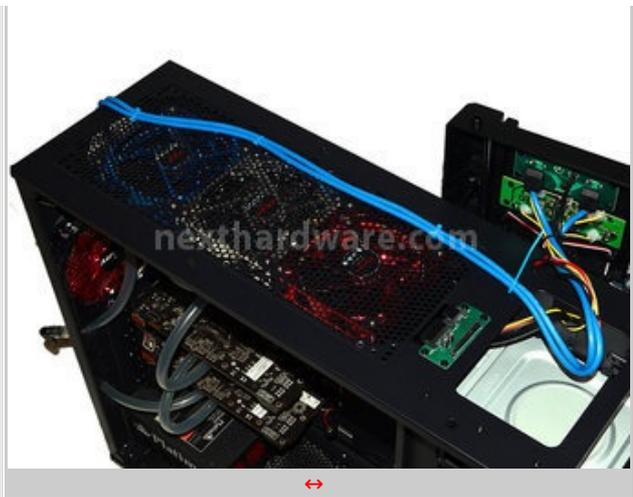
Fissati i cavi per le porte USB 3.0 frontali, passiamo al montaggio della scheda madre, le due VGA e buona parte del sistema di raffreddamento a liquido.
