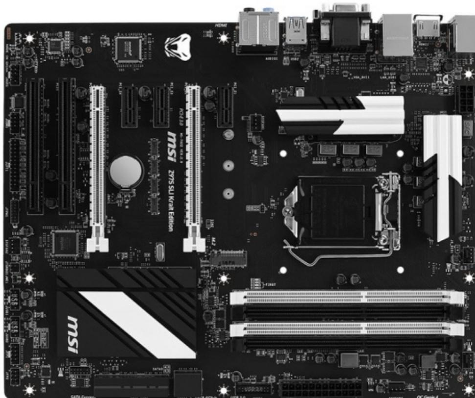
Di elevata qualità la componentistica utilizzata per il sistema di alimentazione che prevede Hi-c CAP: (Condensatori ad alta capacità al Tantalio), SFC (Super Ferrite Choke) e Solid Cap (Condensatori con core in alluminio), tutti in standard Military Class 4 con certificazione MIL-810.
