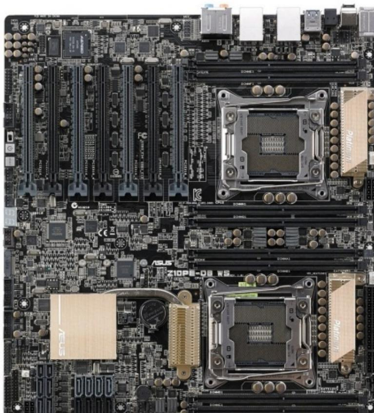
Con due processori installati, il PCH C612 è capace di fornire una connessione PCI Express 3.0 x16 per quattro schede video con i sistemi AMD CrossfireX e NVIDIA SLI.
