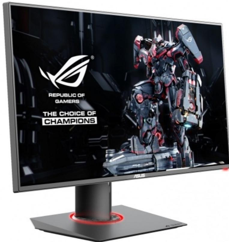
Il pannello di cui parliamo avrà una risoluzione di 2560x1440, un contrasto con rapporto di 1000:1, una luminosità massima di 350cd/m<sup>2</sup> ed angoli di visione pari a 178°/178° ma, cosa più interessante, sarà capace di raggiungere la frequenza di refresh di 144Hz, sinora appannaggio solo di alcuni TN di alta gamma come il ROG Swift di ASUS, anch'esso dotato di pannello AuO.
