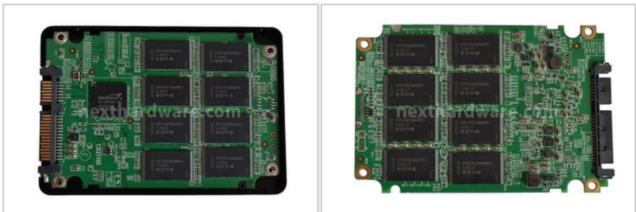
Rimosse le quattro viti che bloccano il coperchio posteriore si accede direttamente al PCB dell'SSD.
