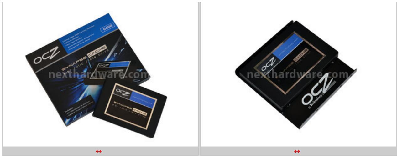
Dal momento che la sua installazione avverrà quasi sicuramente in un sistema desktop dotato di slot da 3.5", OCZ ha incluso un adattatore da 2,5" a 3,5" con relative viti di fissaggio.
