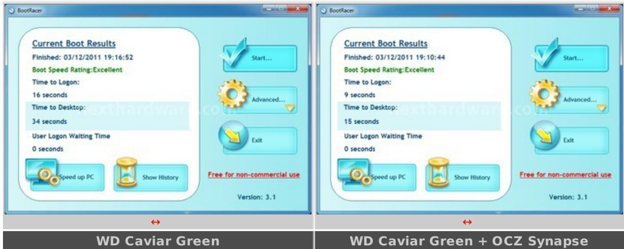
Fin dal primo avvio possiamo constatare come il sistema accelerato con l'SSD OCZ Synapse impieghi meno della metà del tempo necessario per il boot rispetto al solo disco fisso WD Caviar Green.
