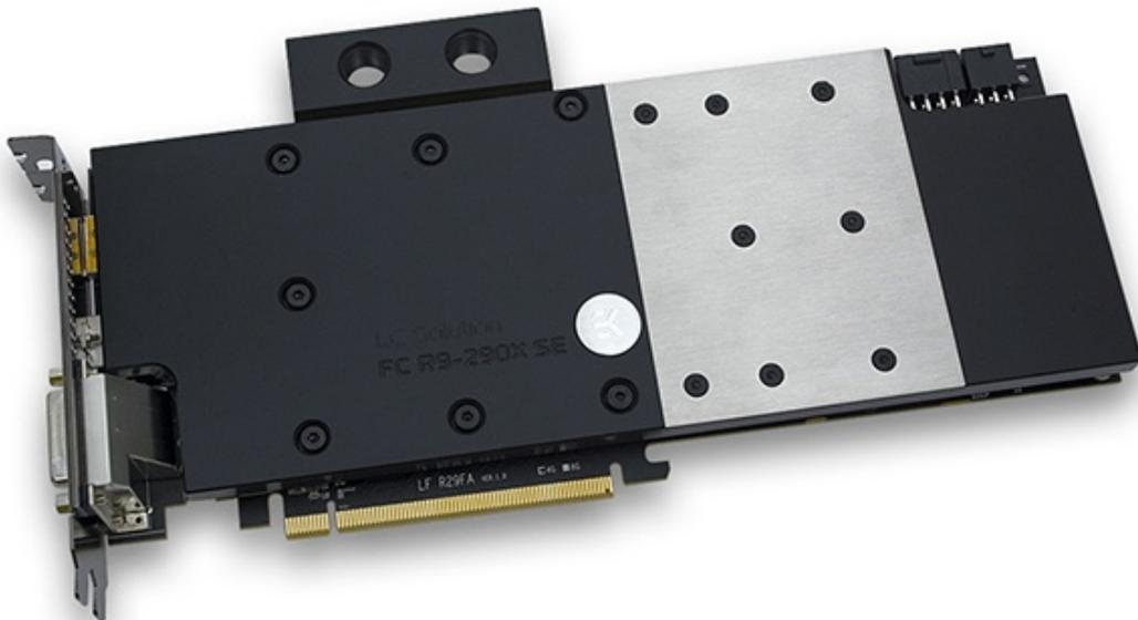
Il prodotto, denominato EK-FC R9-290X SE, raffredda direttamente GPU, RAM e VRM (modulo di regolazione della tensione) grazie alla circolazione dell'acqua direttamente su queste aree critiche, permettendo così alla scheda grafica di rimanere stabile sotto overclock pesanti.
