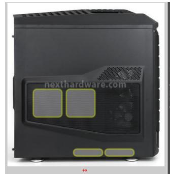
Le ventole opzionali sono in numero di due da 120mm installabili sul pannello laterale sinistro e sempre in numero di due da 120mm posizionabili sul pavimento del case, previa rimozione del cassetto anteriore e del cestello per HDD/SSD da 2,5".
