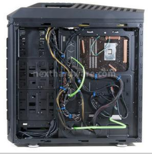
Andiamo quindi ad ordinare i cavi usufruendo della struttura del cabinet che ci offre numerosi punti di ancoraggio.
