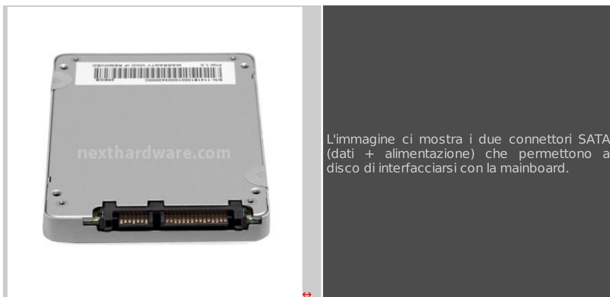
L'immagine ci mostra i due connettori SATA (dati + alimentazione) che permettono al disco di interfacciarsi con la mainboard.
