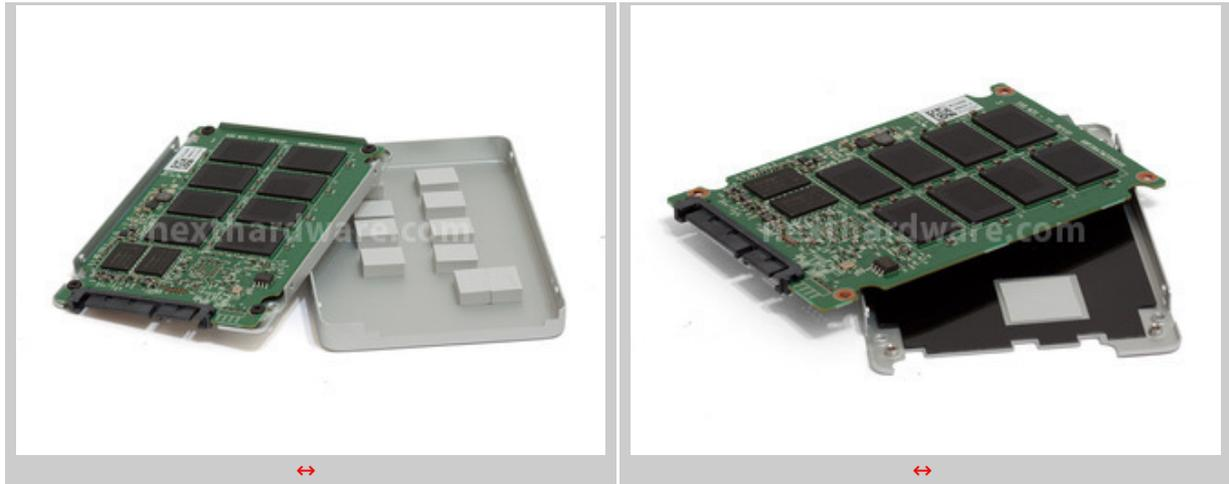
Come visibile dalle foto, Corsair ha previsto un pad termico per ciascuno dei componenti di maggior rilievo di entrambi i lati del PCB, al fine di ottenere un più veloce smaltimento del calore attraverso il telaio in alluminio.
