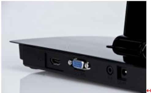
Sul retro della base si trovano I/O ed alimentazione; a partire da sinistra, la porta HDMI, la presa VGA a 15 pin, l'uscita per cuffie e l'alimentazione.
