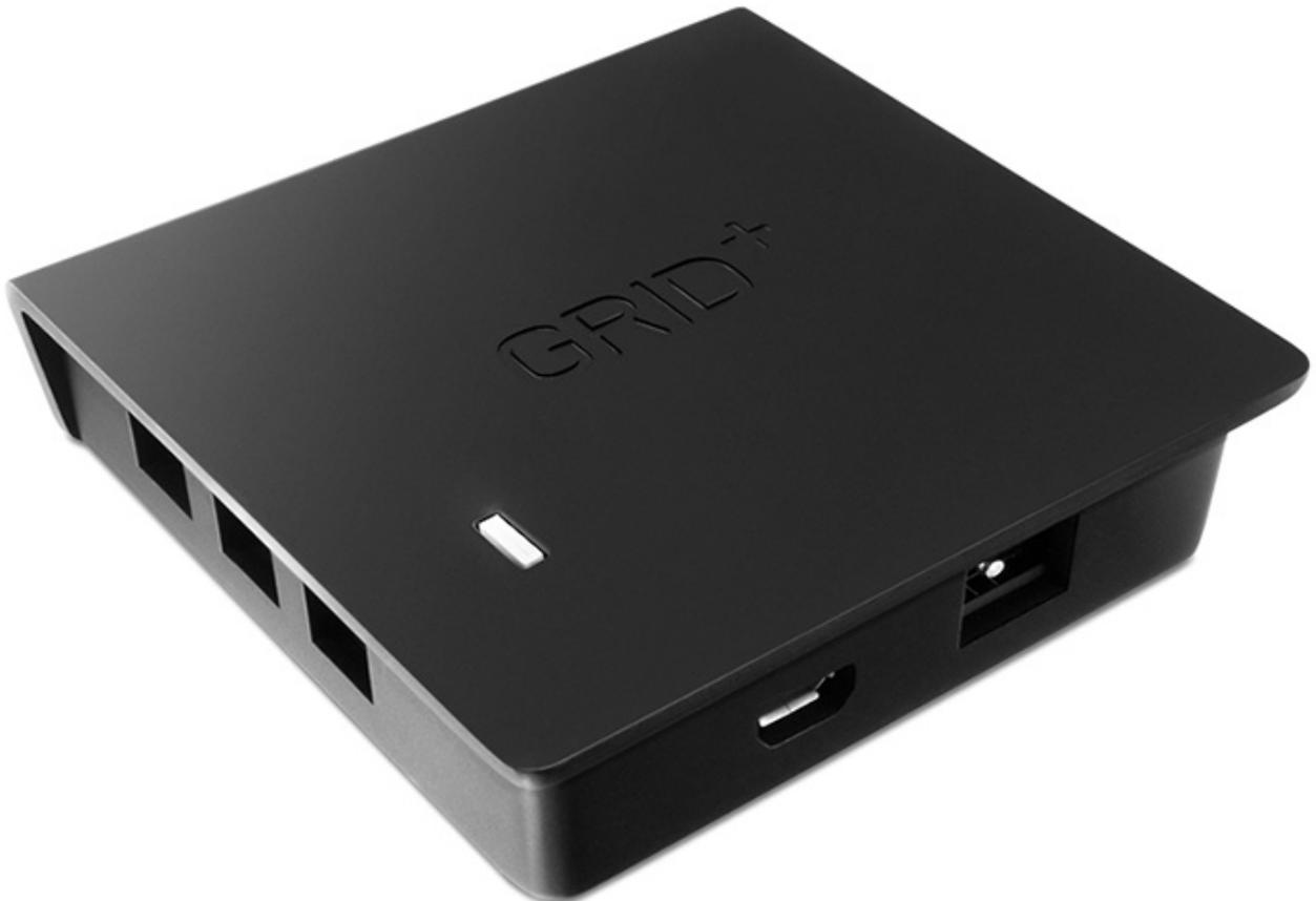
Il GRID+ è un controller digitale per ventole, erede del precedente GRID, in grado di gestire 6 canali e 30W totali in output.
