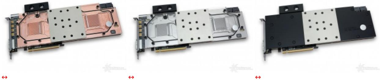
La base è stata realizzata in rame elettrolitico allo stato naturale o nichelato, a seconda della variante, mentre la parte superiore è in materiale acrilico di alta qualità o POM.
