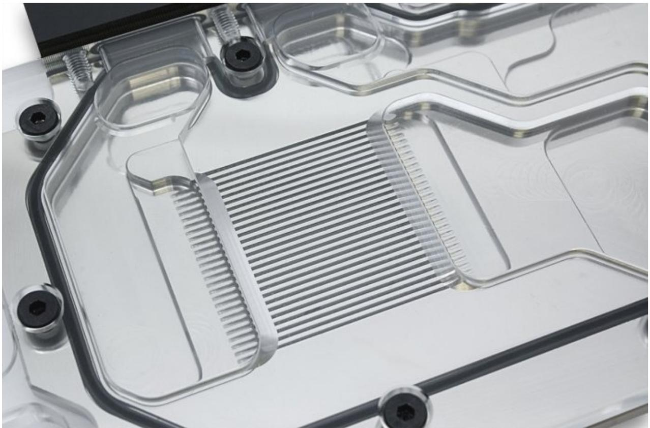
EK ha utilizzato il consueto design interno con microcanali da 0,7mm, che consente prestazioni elevate in termini di raffreddamento ed un flusso elevato, consentendone l'utilizzo anche in abbinamento a pompe non troppo potenti.
