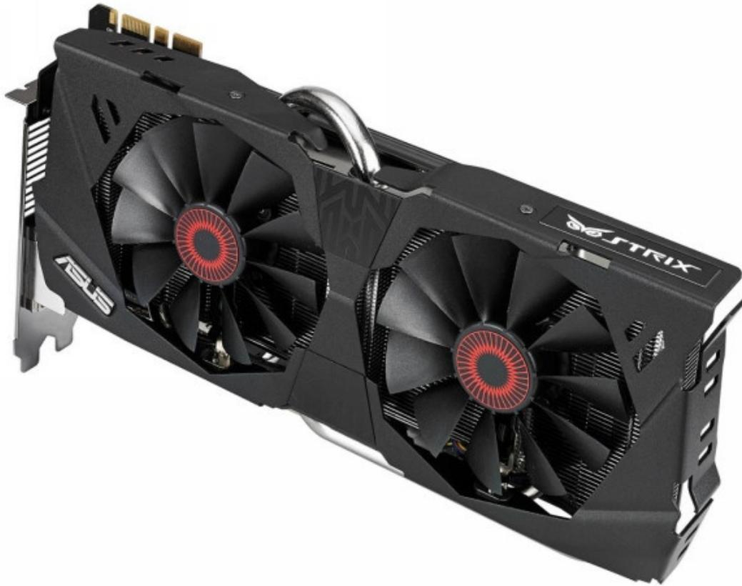
La nuova ASUS GTX 780 STRIX si avvale di una soluzione di raffreddamento DirectCU II in versione ibrida, ovvero caratterizzata da due ventole che rimangono completamente inattive in condizione di idle o di carichi di lavoro molto bassi e iniziano a ruotare soltanto al superamento di una certa temperatura.↔
