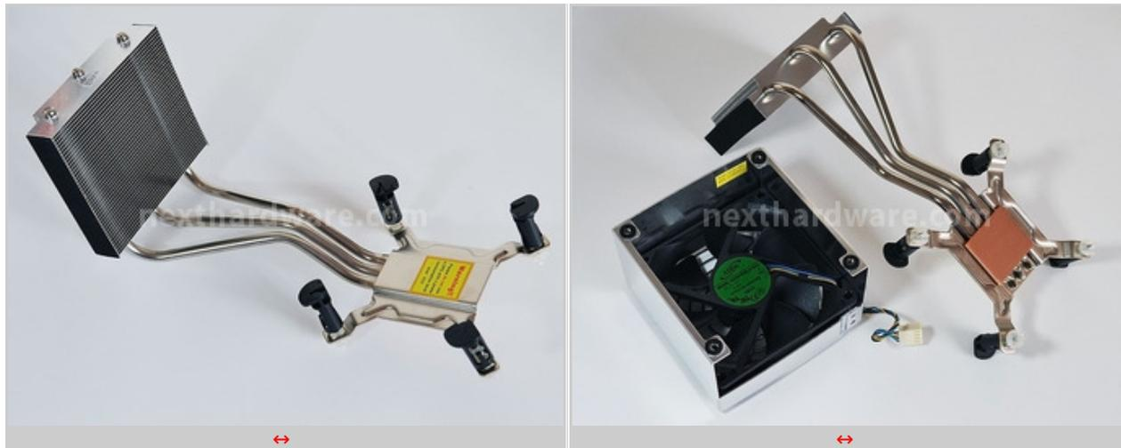
Il sistema di raffreddamento incluso nello Shuttle SH61R4 è composto da un radiatore in alluminio e tre HeatPipes collegate ad una placca in rame da posizionare a diretto contatto con la CPU.
