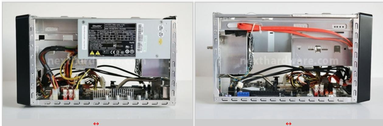
L'alimentatore incluso nello Shuttle SH61R4 è accreditato di una potenza massima di 250W, sufficienti per la maggior parte delle configurazioni che includono al massimo una scheda video di fascia media.
