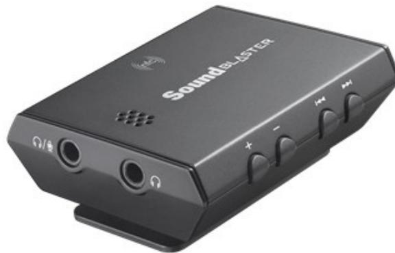
Questi due DAC sono provvisti di un'amplificazione interna per cuffie fino a 600 Ohm, pur mantenendo un rapporto segnale-rumore (SNR) estremamente interessante, di circa 110dB sul modello E3 e di 106dB sul modello E1.
