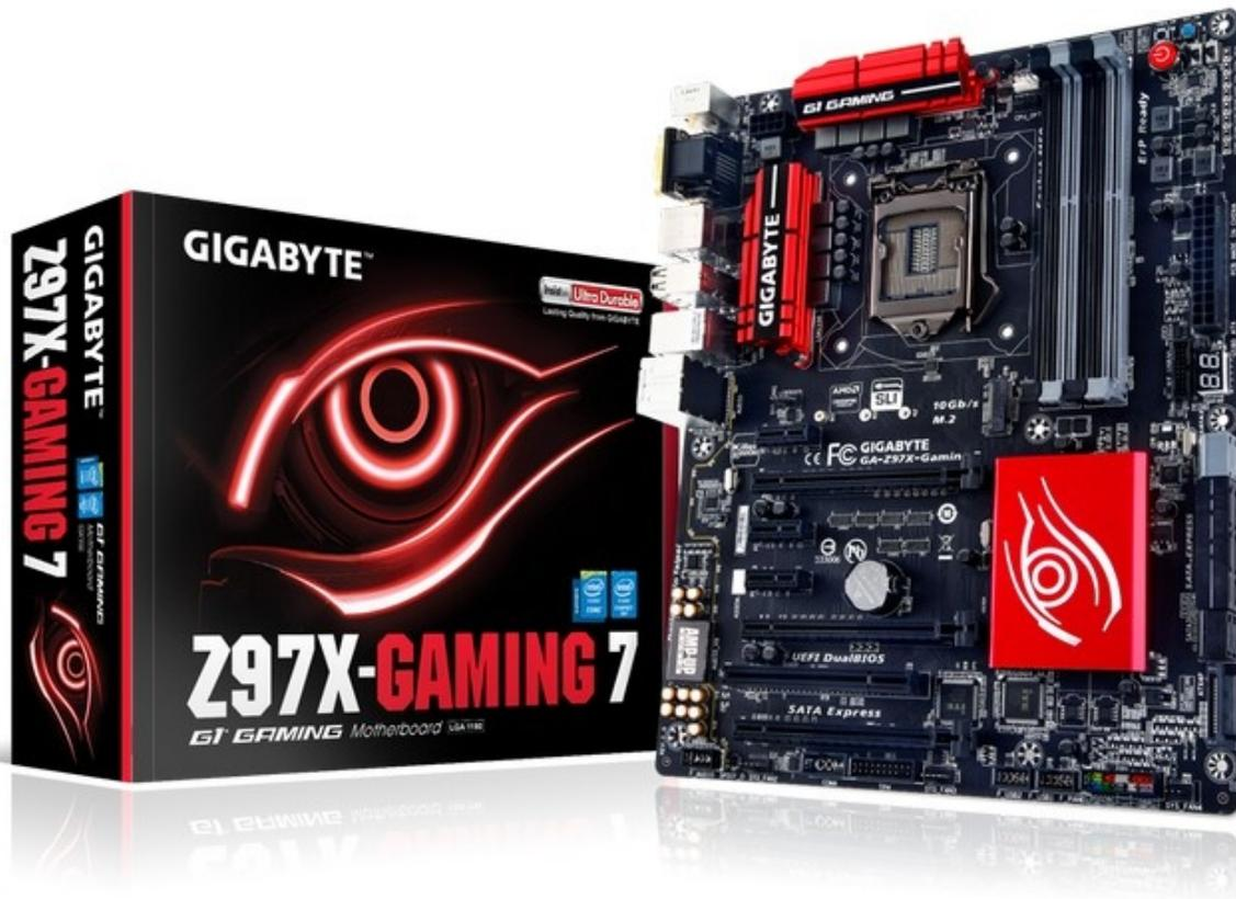
Tutte le schede gaming dispongono di un chip audio Realtek ALC 1150 con tecnologia AMP-UP che prevede un PCB separato, isolamento elettro-magnetico dei componenti analogici, condensatori di qualità e OP-AMP intercambiabili con selettore di guadagno per gestire 600 Ohm di impedenza.
