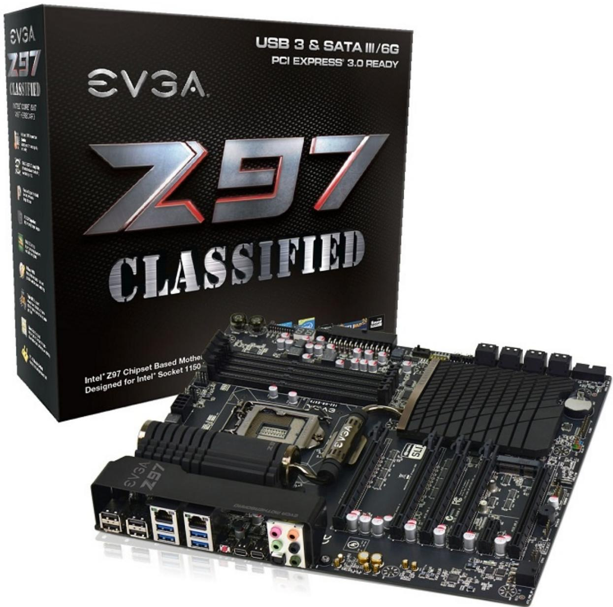
Il modello di punta è, ovviamente, la nuova Z97 Classified, una scheda madre E-ATX in grado di offrire le migliori prestazioni in overclock, con le sue 8 fasi digitali di alimentazione, ed ospitare sistemi Quad-SLI e CrossfireX grazie ai suoi 5 slot PCIe 3.0.
