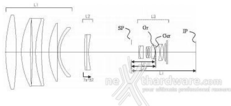
Il secondo è composto da **19** elementi in **12** gruppi, l'elemento in più potrebbe essere il porta filtri posteriore, per il resto le caratteristiche rimangono praticamente le medesime del primo modello ma racchiuse in un barilotto più compatto, **343,5mm**.
