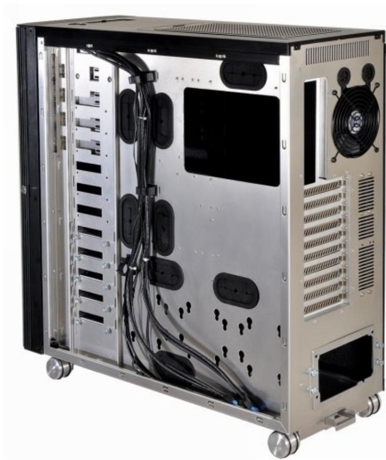
La ventilazione è assicurata da due ventole da 140mm posizionate sul frontale, due da 140mm installate sul top, una posteriore da 120mm ed una da 140mm sul fondo del cabinet.
