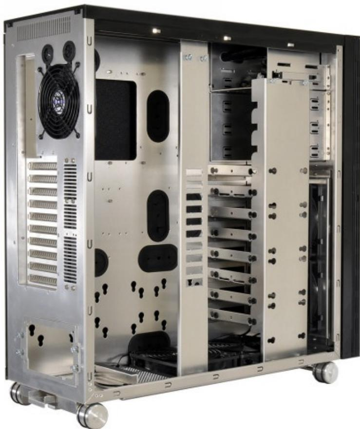
Oltre alle mainboard con i fattori di forma standard il cabinet è in grado di ospitare modelli extralarge fino al formato XL-ATX ed offre, al contempo, dieci slot di espansione per schede aggiuntive.
