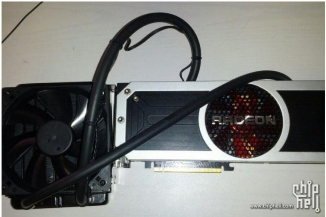
Un sistema di raffreddamento a liquido AiO si occuperà di raffreddare le due GPU da 250W, mentre un dissipatore dotato di ventola raffredderà le memorie, il regolatore di tensione ed il chip bridge PCIe.
