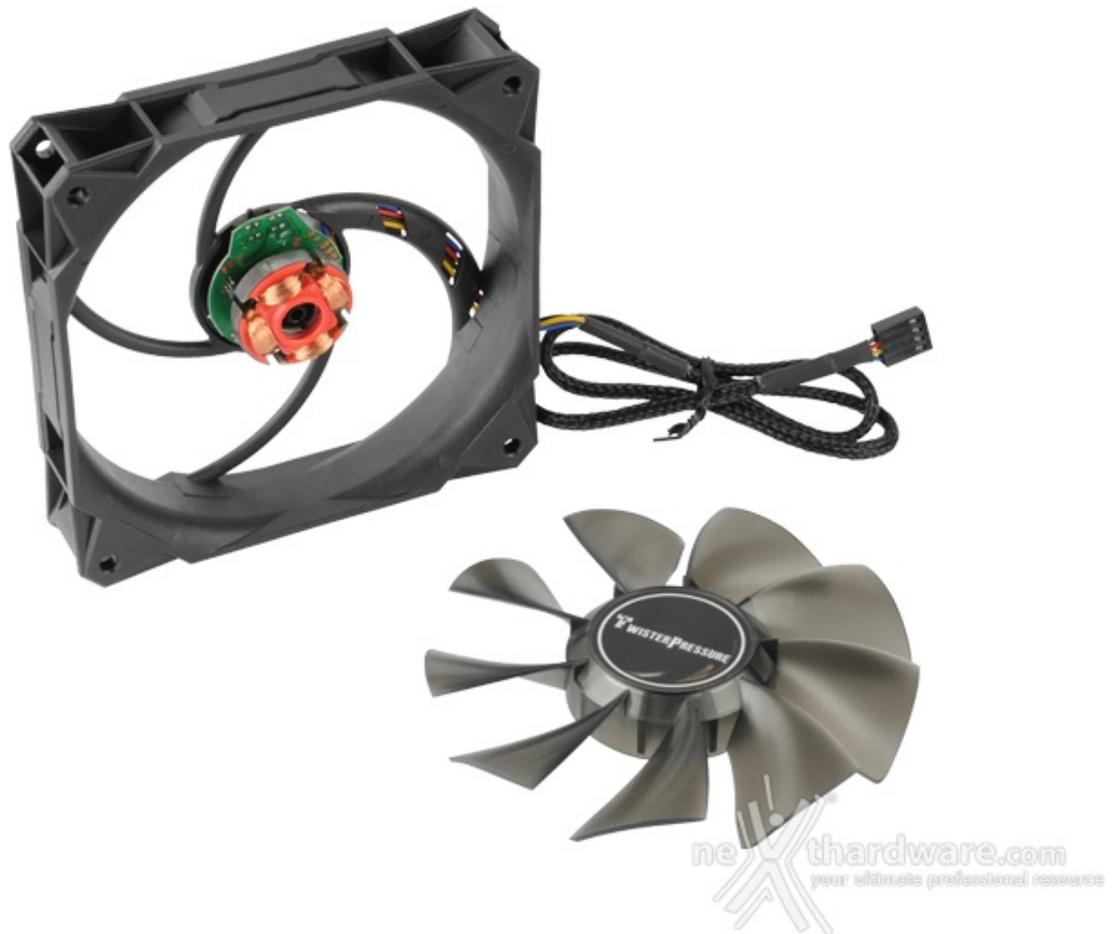
Per mantenere inalterata l'efficienza della ventola anche dopo molte ore di utilizzo, la parte girante può essere facilmente rimossa, senza l'utilizzo di utensili, in modo da svolgere le operazioni di manutenzione e rimuovere lo sporco in eccesso.
