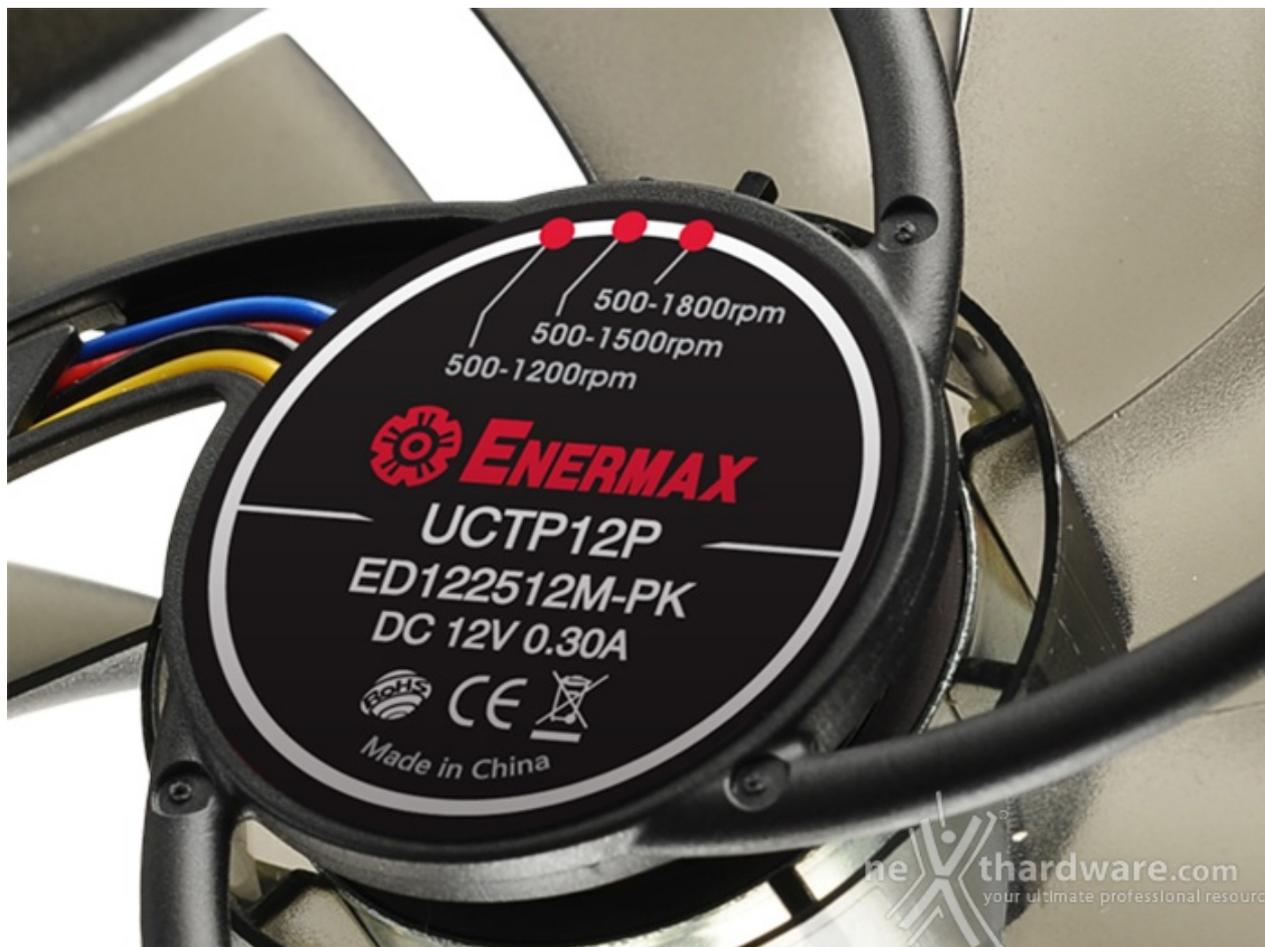
Il collegamento alla mainboard avviene attraverso l'Adjustable Peak Speed (APS) PWM che, oltre a regolarne automaticamente la velocità di rotazione, permette di selezionare il regime massimo di rotazione scegliendo tra 1200, 1500 e 1800 giri, tramite un apposito switch.
