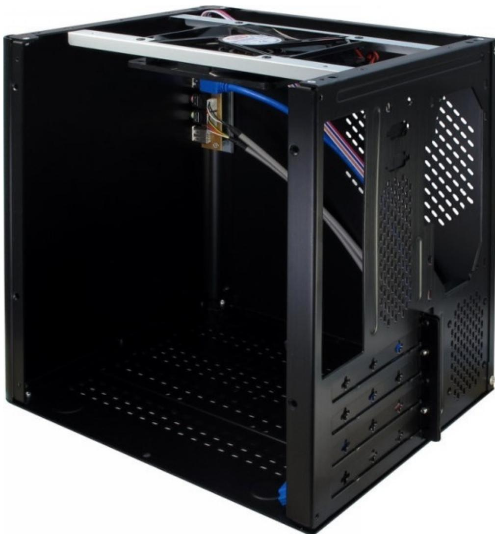
Il raffreddamento, anche in questo caso, è affidato ad una ventola sul top da 120mm ed una posteriore da 60mm, entrambe montate in maniera tale da espellere l'aria calda verso l'esterno, con due prese d'aria presenti sul vano alimentatore e sul pannello laterale.
