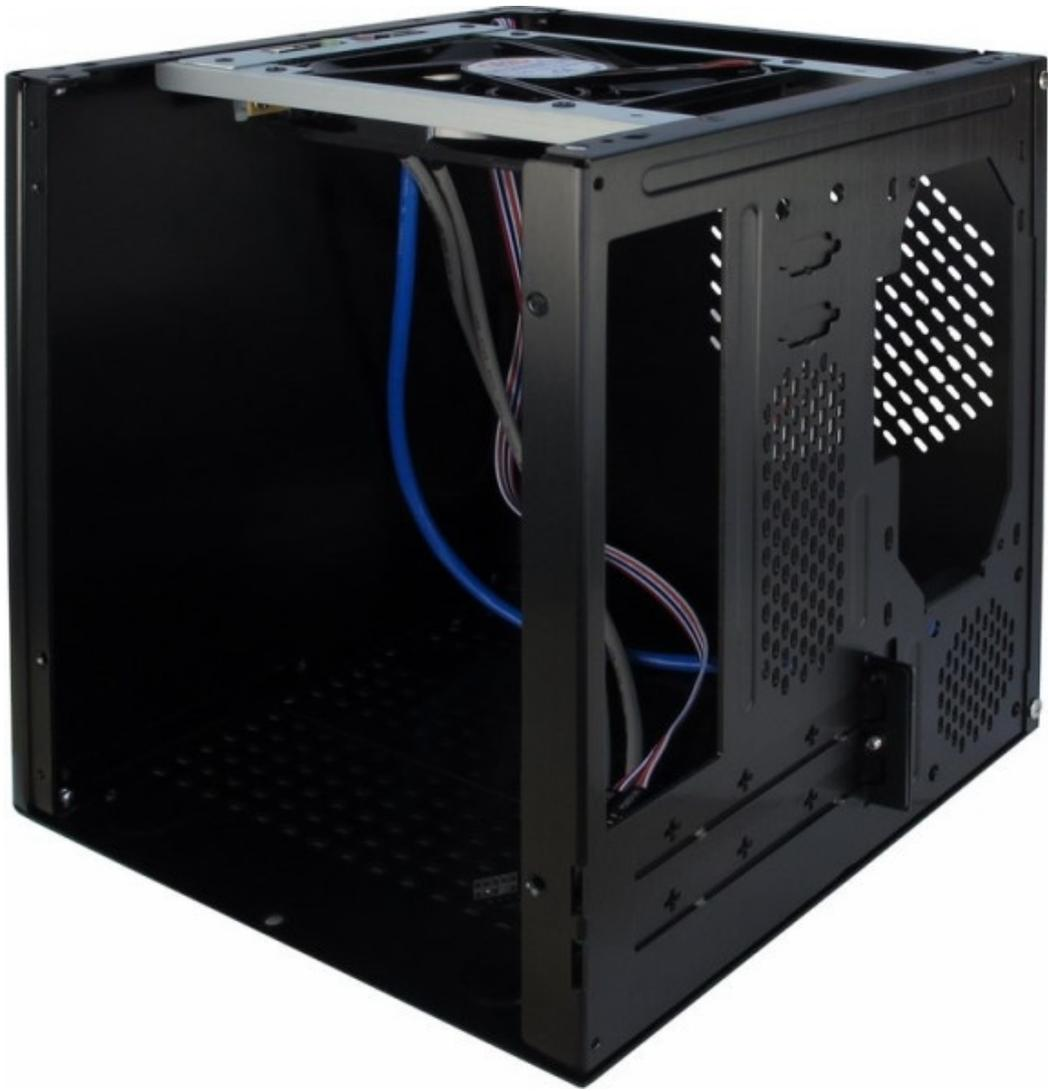
La versione E-D3 Black è la più compatta e misura 260x222x224mm, supportando schede madri in formato Mini-ITX e offrendo due slot di espansione.
