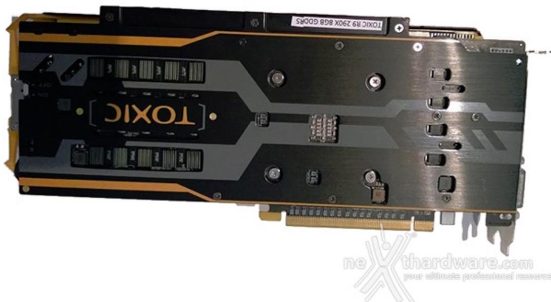
La scheda dispone, ovviamente, dell'efficiente sistema di dissipazione proprietario basato su Vapor Chamber ed un corpo dissipante lamellare di generose dimensioni, questa volta abbinato ad un cattivissimo backplate, il tutto con la consueta livrea nera e gialla.
