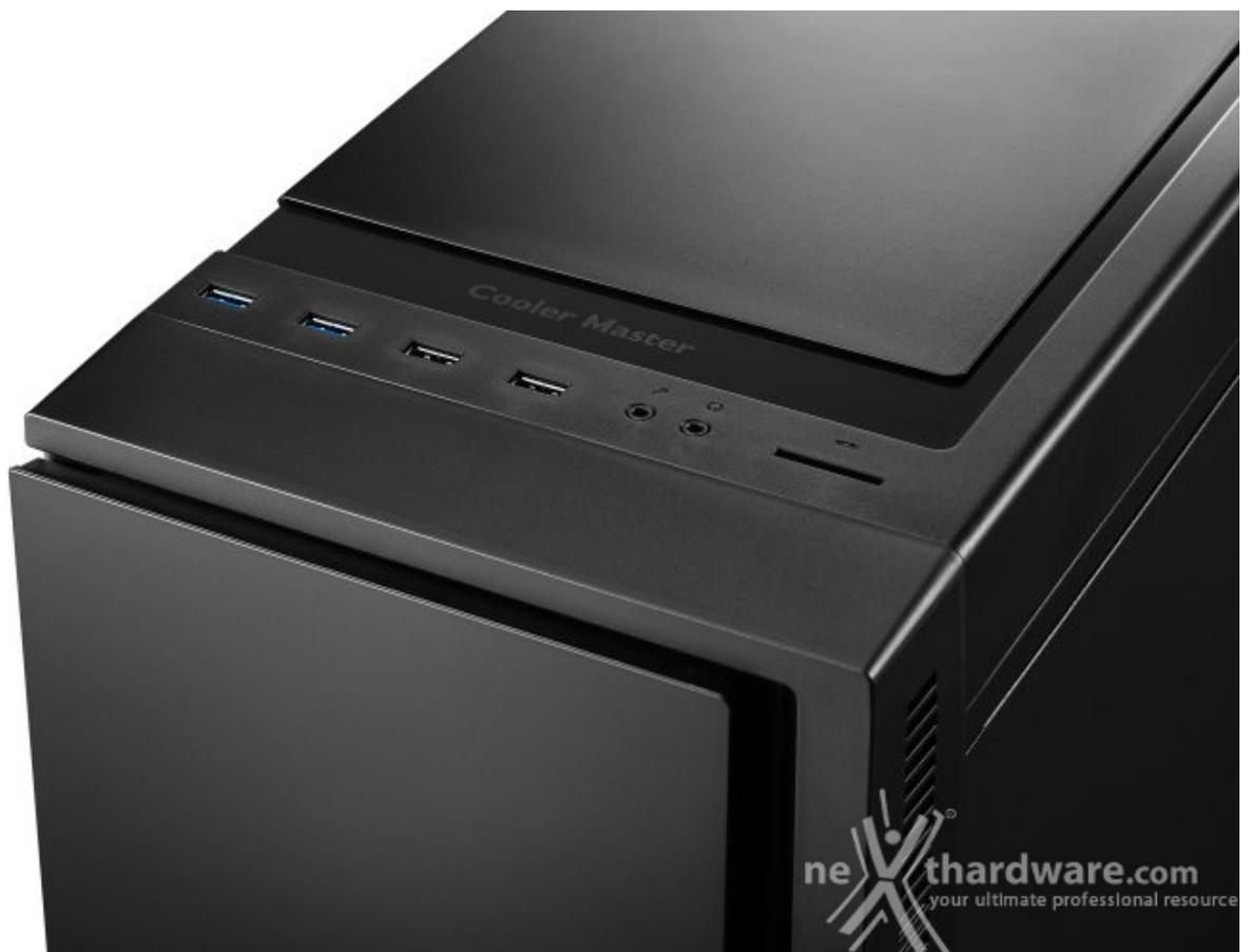
Sotto uno sportellino posizionato nella parte superiore del case troviamo il pannello di controllo delle ventole, due porte USB 3.0, due USB 2.0, gli ingressi Audio In and Out ed un comodo lettore di schede SD.
