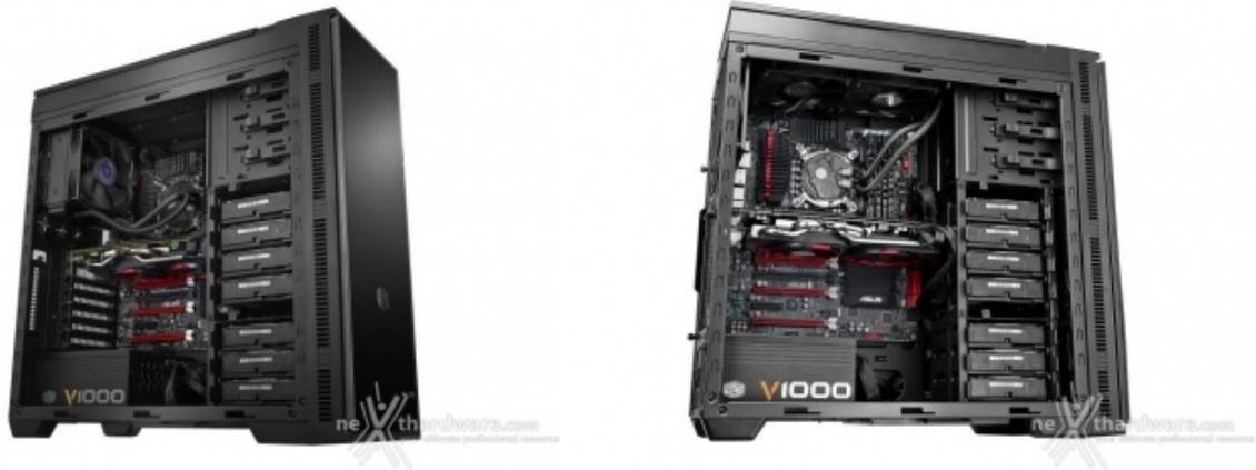
Da primo della classe, anche lo spazio previsto per l'installazione di un impianto a liquido AiO: il Silencio 652S include tutto il necessario per ospitare un radiatore da 240mm sulla parte anteriore o superiore ed uno da 120 nella parte posteriore.
