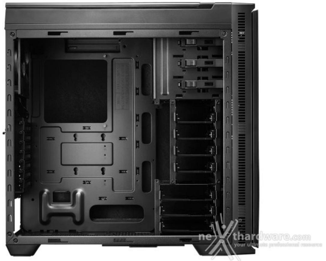
Nel Silencio 6552 si possono facilmente installare schede grafiche di fascia alta con una lunghezza massima di 423mm.
