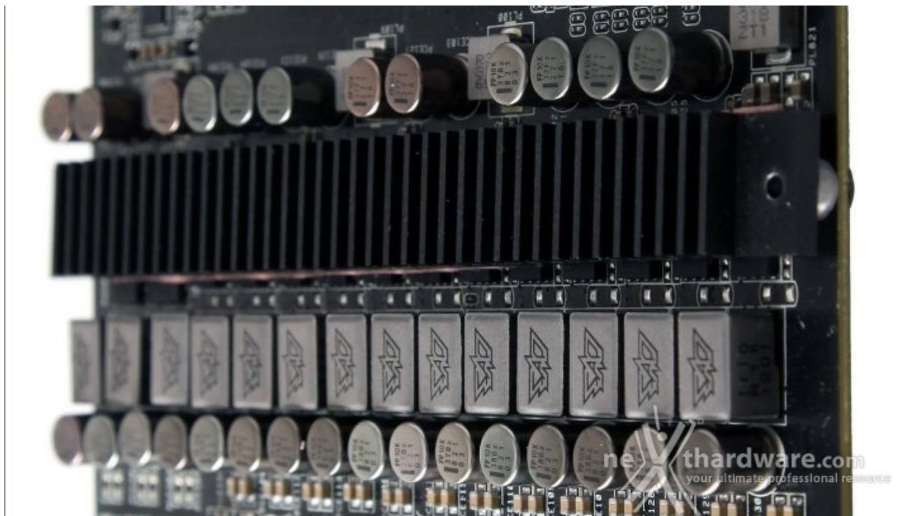
I due modelli MATRIX utilizzano un doppio connettore a 8-pin per l'alimentazione ausiliaria, un circuito di regolazione delle tensioni a 14 fasi DIGI+ ulteriormente potenziato, condensatori ad alta resistenza "Black Metallic" e, infine, un backplate in grado di assicurare un migliore raffreddamento del lato posteriore del PCB e della componentistica ivi ospitata.↔
