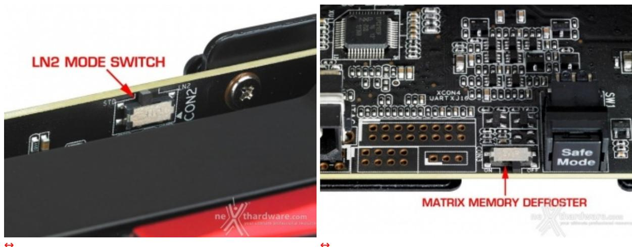
Oltre alle canoniche uscite dual-DVI, HDMI e DisplayPort, le due VGA offrono una serie di peculiarità espressamente dedicate all'overclock estremo come l'interruttore per attivare la modalità LN2 ed il **Matrix Memory Defroster**.
