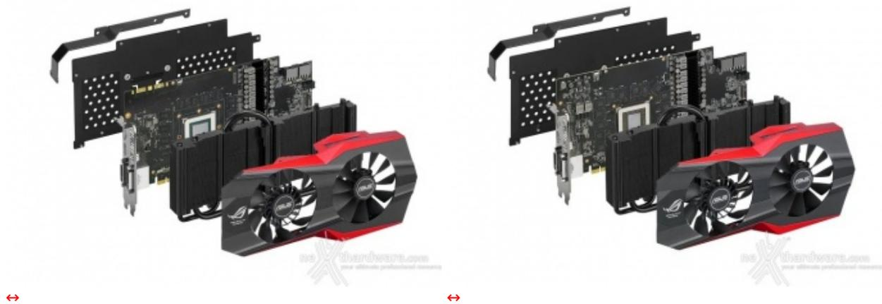
Entrambe le nuove schede utilizzano un PCB personalizzato e sono dotate di un dispositivo di raffreddamento dual-slot che fa uso di due ventole, una delle quali di produzione CoolTech.↔
