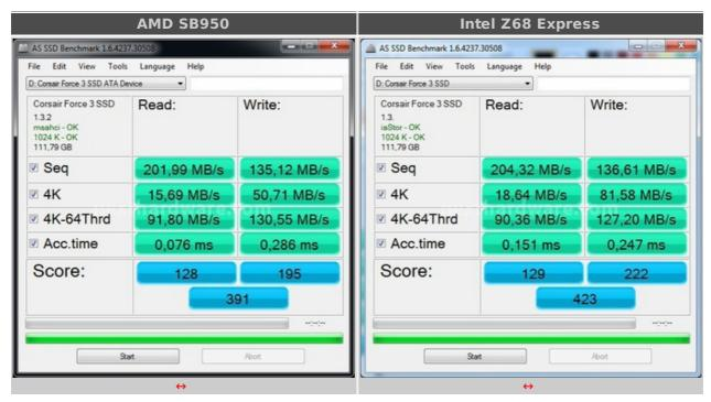
Il test 4K è la vera "bestia nera" per ogni controller e SSD e mette in evidenza i limiti degli stessi.
