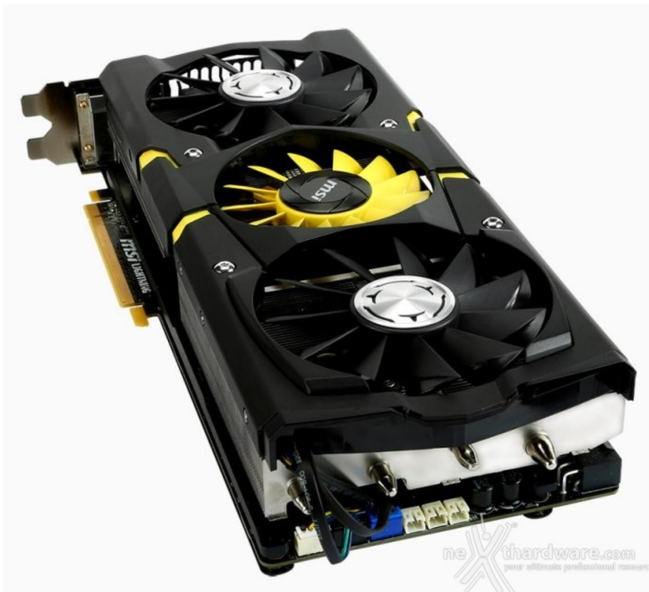
I V-Check Point, infatti, consentono, tramite l'utilizzo di un multimetro, di misurare le tensioni di GPU, memoria e PLL, fornendo agli utenti i dati diretti per una corretta calibrazione, una delle chiavi di successo per l'overclock estremo.
