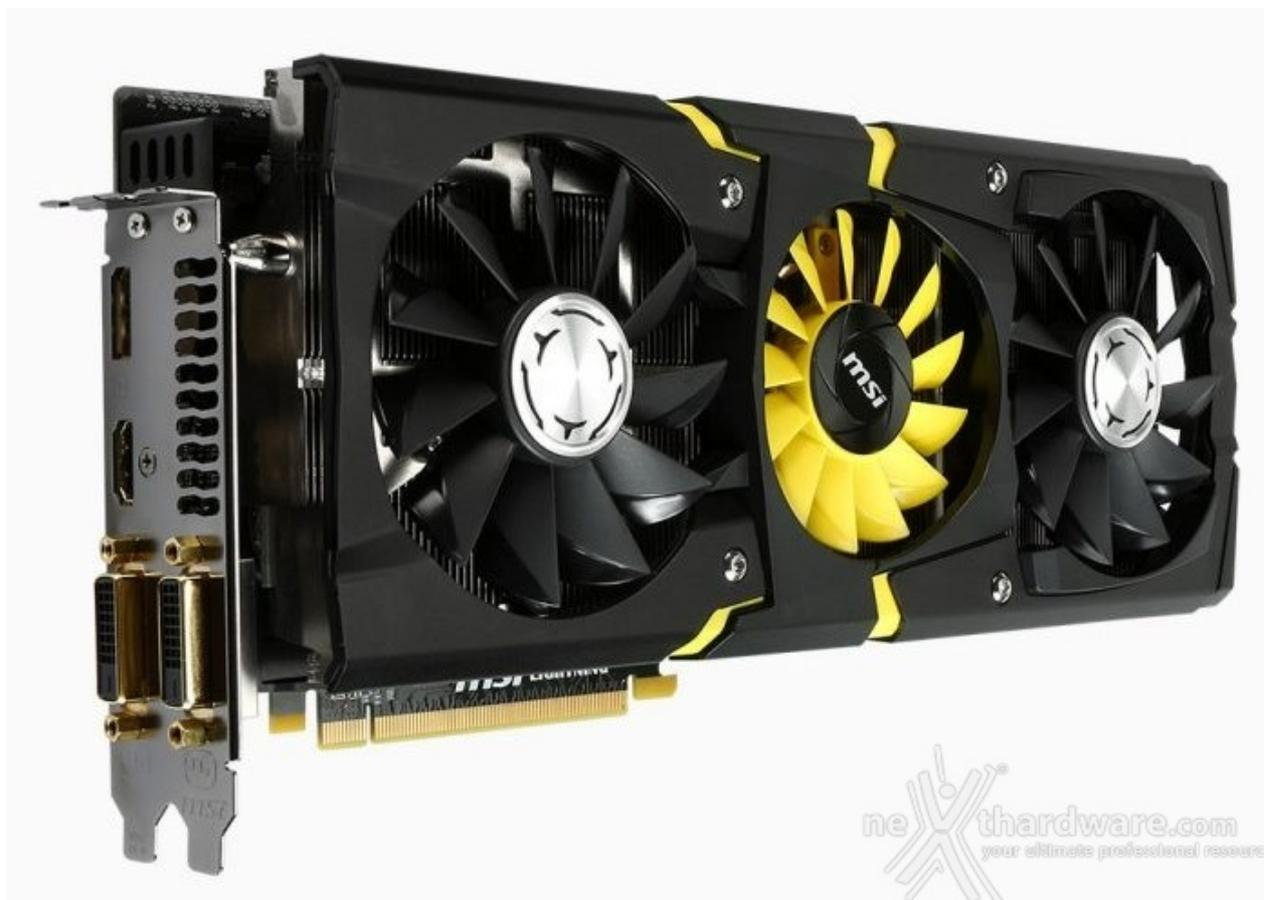
Ben 12 fasi di alimentazione per la GPU, VRM presenti su entrambi i lati del PCB, componenti di altissima qualità in standard Military Class 4 ed un doppio BIOS, di cui uno ottimizzato per LN2, sono solo alcune delle strepitose caratteristiche della nuova VGA ammiraglia di casa MSI.
