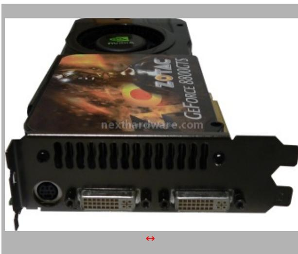
La scheda è dotata di due connettori DVI e di una porta multifunzione per il collegamento S-Video e Component con l'accessorio incluso nella confezione.
