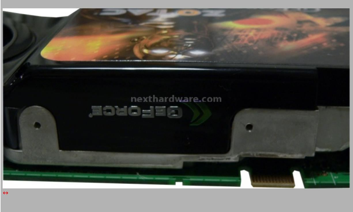
La 8800 GTS supporta lo SLI a due vie, implementa infatti un solo connettore per il collegamento con la seconda VGA, non prevedendo, come il modello GTX e ULTRA, un secondo connettore per collegare fino a 3 schede video, configurazione possibile con le future schede madri basate su chipset NVIDIA e nuovi driver ForceWare.
