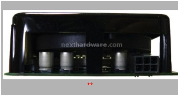
La sezione di alimentazione è coperta dall'involucro del dissipatore. Si possono comunque notare i condensatori metallici, segno di una cura particolare nella creazione di un circuito di alimentazione di qualità. E' presente un solo connettore PCI-ex 6 pin per l'alimentazione aggiuntiva. Nvidia consiglia un alimentatore a almeno 400w con 26A sulla linea da 12v per un corretto funzionamento della scheda.
