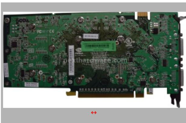
Il retro non è caratterizzato da alcun dissipatore, i moduli di memoria e il circuito di alimentazione sono interamente posti sulla parte frontale del pcb. In alto si può notare il connettore per la modalità SLI. Non è presente il chip NVIO, le sue funzionalità sono state incluse all'interno del G92.
