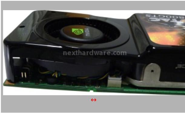
La posizione della ventola è caratteristica, infatti non è in linea con il PCB ma inclinata di alcuni gradi. Non è chiaro il motivo di tale scelta costruttiva, probabilmente ciò ha permesso di accelerare il flusso dell'aria attraverso il dissipatore senza dover aumentare la velocità di rotazione della ventola stessa.
